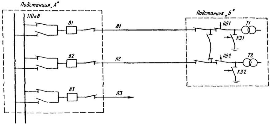
Рис.3. Схема участка электросети напряжением 110 кВ с двумя подстанциями:
