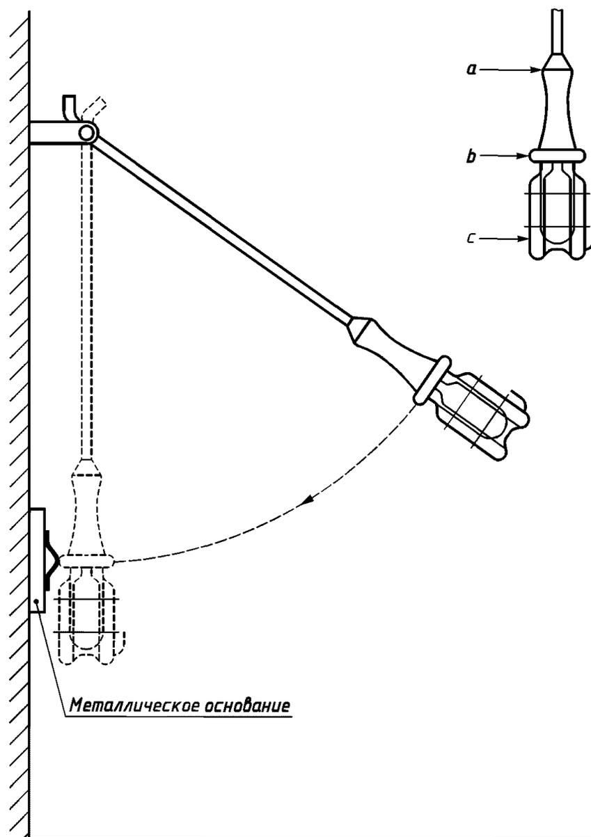
Рисунок 1 — Устройство для испытания светильников на удар
