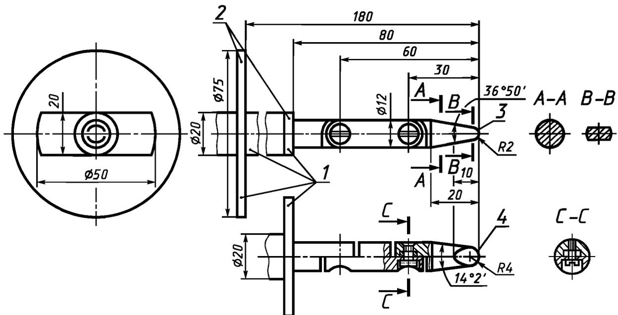
1 — изоляционный материал; 2 — стопорная плата; 3 — цилиндр; 4 — сфера
