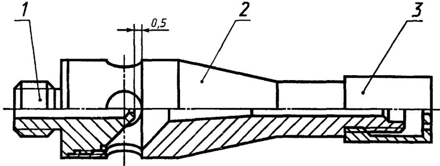
1 — газовая форсунка; 2 — трубка горелки; 3 — стабилизатор пламени
