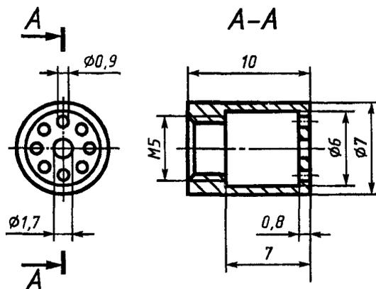
Рисунок Б.4 — Стабилизатор пламени
