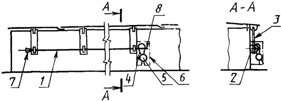
1 — канат, 2 — крепежное ушко, 3 — стальная пластина, 4 — связывающий элемент, 5 — гломба, 6 — предохранительная коробка, 7 — головка, 8 — наконечник
