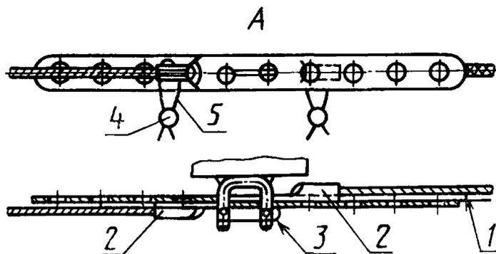
1 — стальной проволочный канат; 2 — наконечник; 3 — замок; 4 — пломба; 5 — связывающий элемент; б — крепежное ушко
