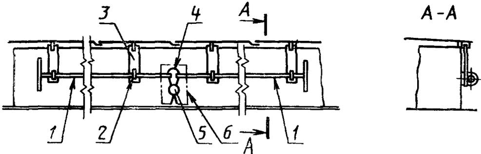
1 — пруток; 2 — крепежное ушко, 3 — стальная пластина, 4 — связывающий элемент, 5 — пломба, 6 — предохранительная коробка
