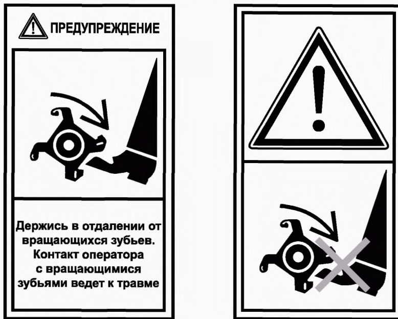
Рисунок 7 — Пример знаков безопасности для предупреждения о риске от контакта с вращающимися зубьями
