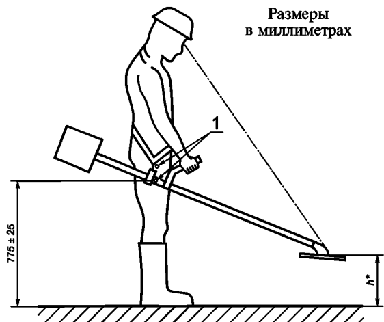
Рисунок 2 — Положение машины при испытании
