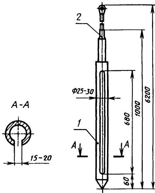
1 — корпус, 2 — держатель с заземлением
