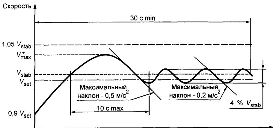
\*  $V_{\max}$  представляет собой максимальную скорость, развиваемую транспортным средством в первом полупериоде кривой чувствительности.
