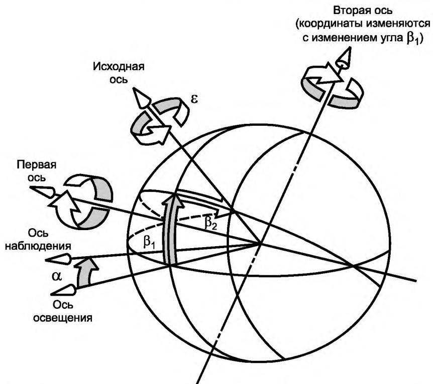
Система углов МКО для определения и измерения светоотражения. Первая ось перпендикулярна к плоскости, в которой проходят ось наблюдения и ось освещения. Вторая ось перпендикулярна как к первой оси, так и к исходной оси. Все оси, углы и направления вращения показаны положительными.
