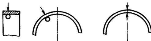
а) Единичное (отдельное) измерение с помощью контакта (механический/электронный калибр)
