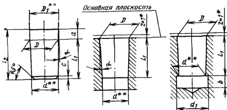
\*  $z$  — наибольшее допускаемое отклонение положения основной плоскости, в которой находится диаметр  $D$ , от ее теоретического положения.
