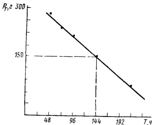
По графику находят время, за которое происходит изменение разрывной нагрузки на 50% при контакте с испытуемой землей.
