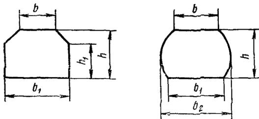
$b$ —ширина наружной пласти,  $b_1$ —ширина внутренней пласти;  $b_2$ —ширина бруса по непропиленным сторонам,  $h$ —толщина бруса,  $h_1$ —высота пропиленной боковой стороны
