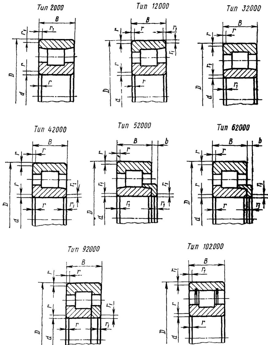
$d$  — номинальный диаметр отверстия внутреннего кольца;  $D$  — номинальный диаметр наружной цилиндрической поверхности наружного кольца;  $B$  — номинальная ширина подшипника;  $r$  — координата монтажной фаски;  $r_{s \text{ min}}$  — наименьший предельный размер  $r$ ;  $r_1$  — координата монтажной фаски;  $r_{1s \text{ min}}$  — наименьший предельный размер  $r_1$ .
