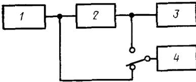
1—поверяемый генератор; 2—режекторный фильтр; 3—анализатор гармоник; 4—вольтметр
