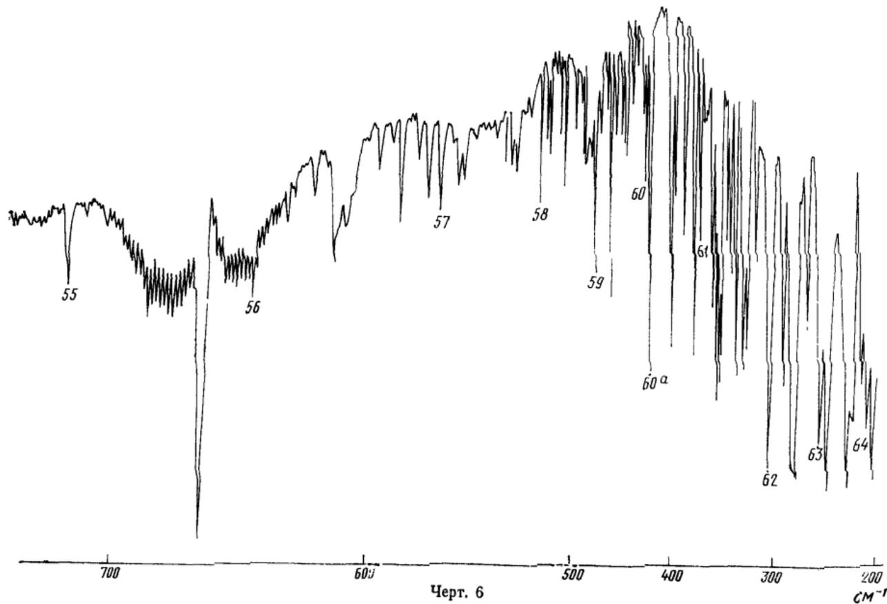
Спектр поглощения полистирола при регистрации на спектрофотометрах типов ИКС-22А, ИКС-24 и ИКС-29
