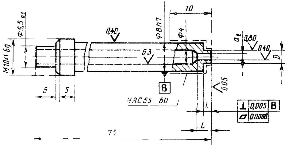
Контрольные измерительные сопла используют для проверки длинномеров, выпускаемых без измерительной оснастки. Эти сопла могут быть использованы в качестве параллельного сопла, а также для замены пробки соплами.
