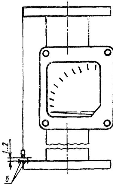
Отклонение  $\delta$  отвеса от края нижнего фланца при приложении нити к краю верхнего фланца в любой вертикальной плоскости должно быть не более 2 мм.
