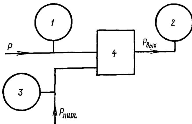
1—образцовый прибор для задания (измерения) избыточного давления, 2—образцовый прибор для измерения (задания) выходного сигнала, 3—образцовый прибор для контроля за давлением воздуха питания, 4—проверяемый прибор
