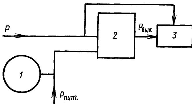
1—образцовый прибор для контроля за давлением воздуха питания, 2—проверяемый прибор, 3—образцовый преобразователь для сравнения коэффициента преобразования
