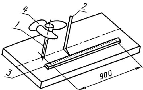
1—вал; 2—указатель; 3—шкала; 4—крыльчатка
