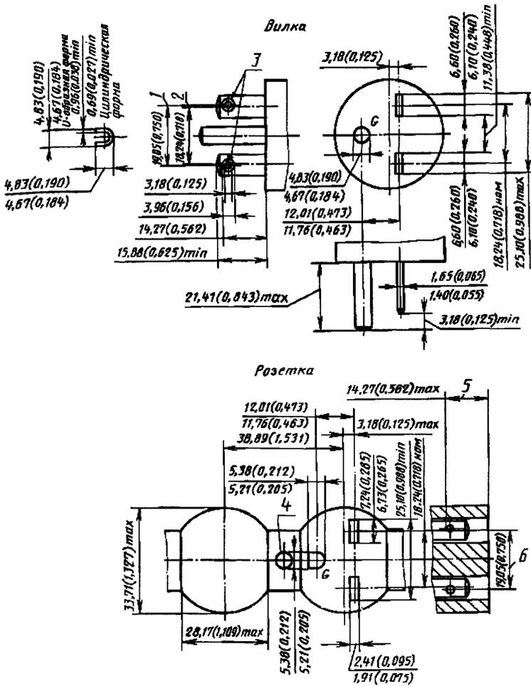
Розетка и вилка двухполюсные с заземляющим контактом на 20 А, 250 В
