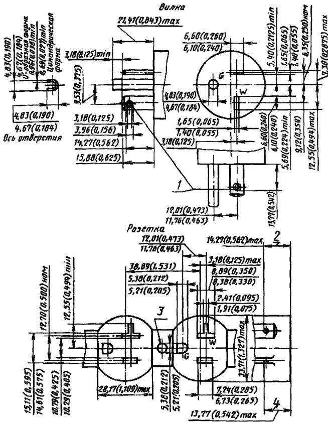
Розетка и вилка двухполюсные с заземляющим контактом на 15 А, 250 В
