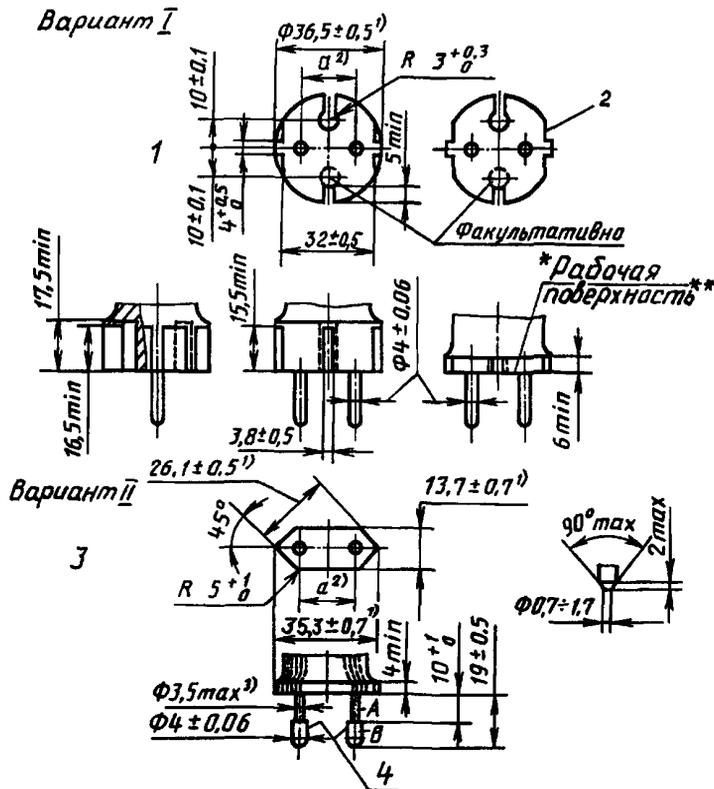
1 — вариант I, круглая вилка; 2 — вариант круглой вилки; 3 — вариант II, плоская вилка; 4 — слегка закругленные кромки
