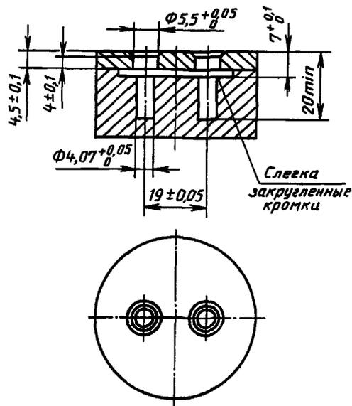
Вилка должна вводиться в калибр без чрезмерных усилий до соприкосновения ее рабочей поверхности с поверхностью калибра.
