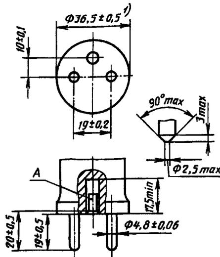
A — контактная гильза должна быть упругой в пределах размеров от 4,3 до 5,1 мм. Может иметь форму, отличную от трубчатой.
