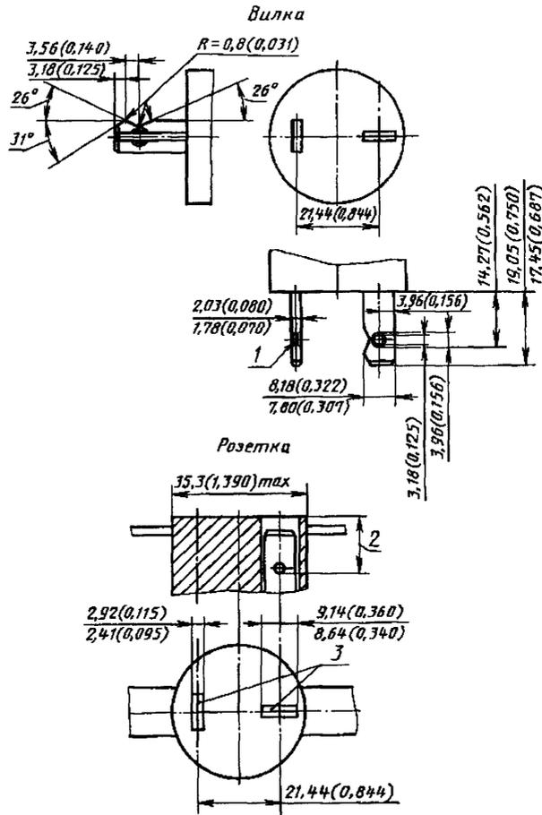
Розетка и вилка двухполюсные с заземляющим контактом на 15 А, 125 В
