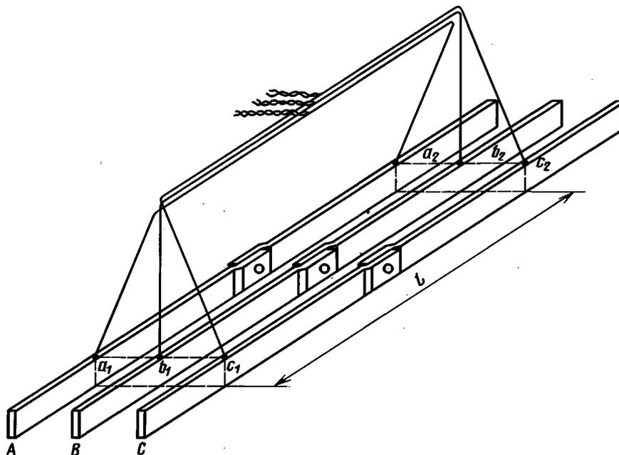
Кожух, оболочки и другие детали прямой секции шинопровода условно не показаны. Подключение к потенциометру проводится свитыми попарно проводами
