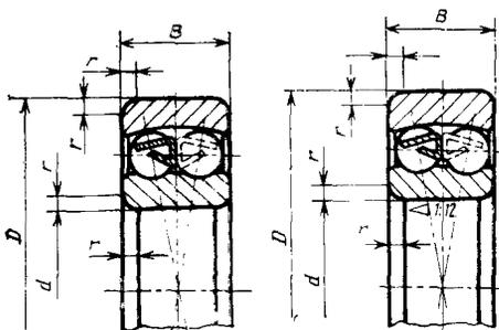
$d$  — номинальный диаметр отверстия внутреннего кольца;  $D$  — номинальный диаметр цилиндрической поверхности наружного кольца;  $B$  — номинальная ширина подшипника;  $r$  — номинальная координата монтажной фаски.
