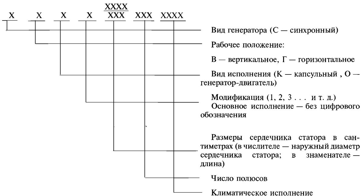
Пример условного обозначения гидрогенератора синхронного, вертикального, основного исполнения, с наружным диаметром сердечника статора 940 см и длиной сердечника статора 235, числом полюсов 30, климатического исполнения УХЛ4:
