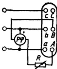
$R$  — регулируемый резистор;  $P_{\Phi}$  — фазометр;  $A, B, C, a, b, c$  — зажимы испытуемого трансформатора
