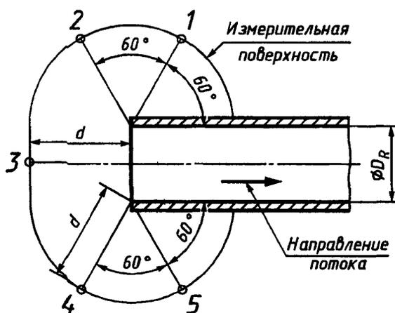
$D_R$  — внутренний диаметр трубопровода
