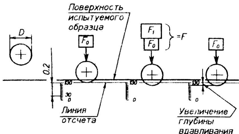
Рисунок 4 — Испытание на твердость методом вдавливания
