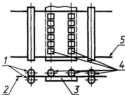
1 — направляющие ролики; 2, 5 — испытуемый образец; 3 — металлическая пластинка, соединенная с источником высокого напряжения; 4 — заземленные испытательные ролики
