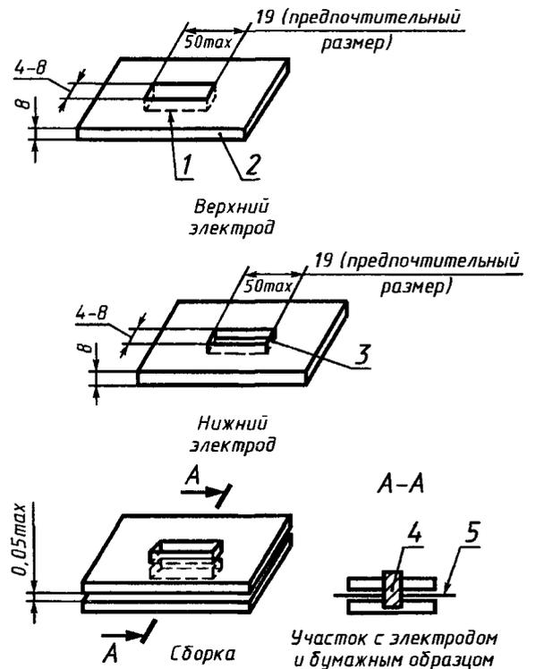
1 — паз; 2 — электроизоляционный материал, например полиметилметакрилат; 3 — выемка; 4 — ртуть; 5 — бумага
