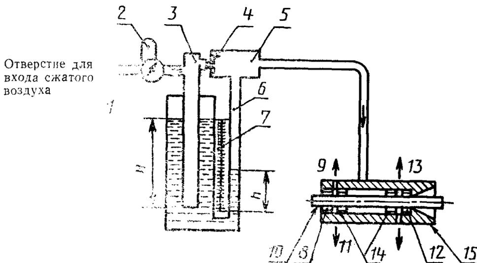
1 — расширяющая форсунка  $D$ ; 2 — редукционный клапан с воздушным фильтром; 3 — давление  $H$  мм водного столба; 4 — основная форсунка; 5 — давление  $(H-h)$  мм водного столба; 6 — водяной манометр; 7 — шкала; 8 — наружное кольцо; 9 — проход воздуха; 10 — сигарета; 11 — проход воздуха; 12 — наружное кольцо; 13 — проход воздуха; 14 — внутреннее кольцо; 15 — измерительная головка
