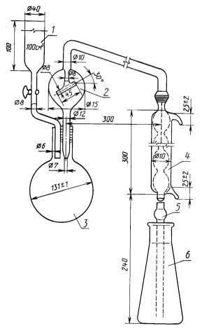
I — цилиндрическая загрузочная воронка с краном; 2 — предохранительный объем; 3 — круглодонная колба; 4 — холодильник; 5 — расширительный резервуар; 6 — приемная колба
