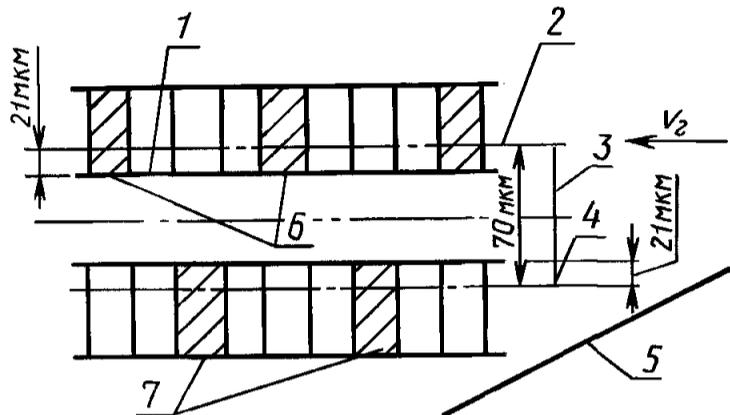
1 — край строчки видеозаписи; 2 — траектория движения видеоголовки; 3 — зазор; 4 — базовый край ВГ; 5 — базовый край ленты; 6 — сигнал А; 7 — сигнал В;  $V_2$  — направление записи головки
