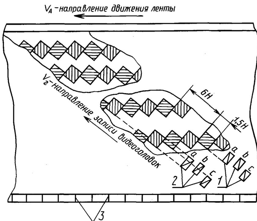
1 — видеоголовка (канал 1); 2 — видеоголовка (канал 2). Положение видеоголовок относительно строчек видеозаписи в зависимости от фазового сдвига  $\varphi$ : a — при  $\varphi = 0,4$  мкс; b — при  $\varphi < 0$  мс; c — при  $\varphi > 0,8$  мс
