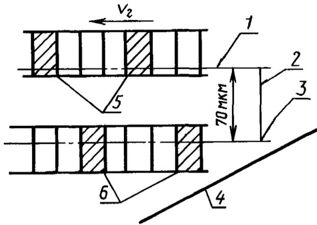
1 — траектория движения ВГ; 2 — зазор ВГ; 3 — базовый край ВГ; 4 — базовый край ленты; 5 — сигналы А; 6 — сигналы В
