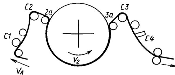
$V_{л}$  — направление движения ленты;  $V_{г}$  — направление вращения видеоголовок; 2а, С1, С2 — входные стойки; 3а, С3, С4 — выходные стойки
