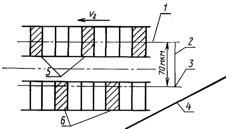
1 — траектория движения ВГ; 2 — зазор ВГ; 3 — базовый край ВГ; 4 — базовый край ленты; 5 — сигналы А; 6 — сигналы В
