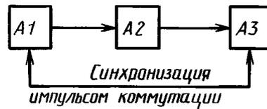
*A1* — проверяемый или настраиваемый видеоманитфон; *A2* — стенд обработки измерительного сигнала (п. 4.2.15);
