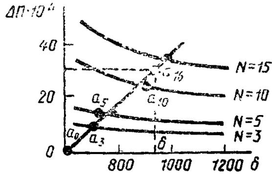
$\Delta n$  — разность показателей преломления пробы и образца;  $N$  — порядковый номер интерференционной полосы;  $\delta$  — отсчет с момента исчезновения видимости границ пробы в иммерсионной жидкости;  $a_i$  — отсчеты с момента прохождения через ребро рабочей грани образца интерференционных полос:  $i=0, 3, 5, 10, 15$
