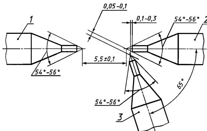
1 — одиночный заземленный электрод; 2 — высоковольтный электрод; 3 — ионизационный электрод
