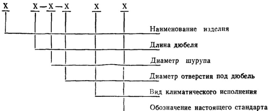
Пример условного обозначения дюбеля длиной 25 мм, с шурупом диаметром 4 мм, отверстием под дюбель 6 мм, вида климатического исполнения УЗ:
