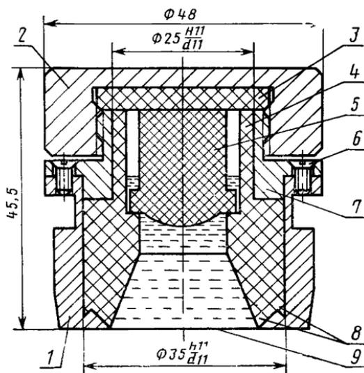
1 — цилиндрический металлический корпус, 2 — крышка (гайка); 3 — прокладка из кислотостойкой резины, 4 — фторопластовый вкладыш, 5 — пробка фторопластовая, 6 — винтовое соединение, 7 — металлический фланец, 8 — конические выступы, 9 — полимерная пленка
