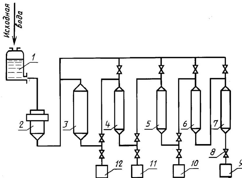
1 — бутылка с тубусом; 2 — фильтр грубой очистки; 3 — фильтр для отделения органических веществ; 4, 5 — *H*-катионитовые фильтры; 6 — анионитовый фильтр; 7 — комбинированный (катионито-анионитовый) фильтр; 8 — клапаны; 9—12 — бутылки (канистры)
