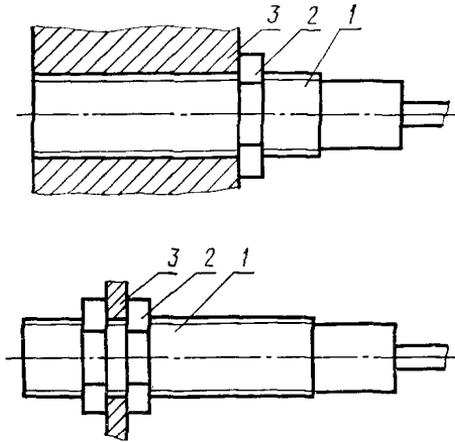
1 — выключатель; 2 — гайка; 3 — установочная панель
