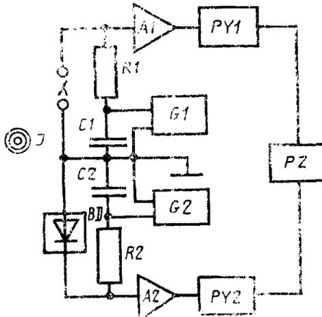
*I*—источник импульсов ионизирующего излучения; *X*—входные выводы установки; *BD*—ППД-монитор; *R1*, *R2*—резисторы утечки; *C1*, *C2*—блокирующие конденсаторы; *A1*, *A2*—зарядочувствительные усилители; *G1*, *G2*—источники рабочего напряжения; *PY1*, *PY2*—интегрирующие измерители; *PZ*—измеритель отношений сигналов
