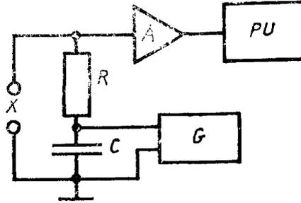
$X$ —выводы для подключения ППД;  $R$ —резистор утечки;  $C$ —блокирующий конденсатор;  $A$ —ЗУ;  $G$ —источник рабочего напряжения;  $PU$ —измеритель среднего квадратического значения переменного напряжения
