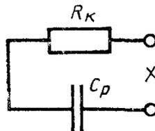
$R_k$ —калибровочный резистор;  $C_p$ —разделительный конденсатор
