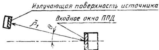
$\bar{\Theta}$  — средний угол падения ионизирующего излучения;
