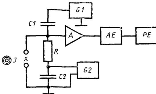
*I*—источник ионизирующего излучения; *X*—входные выводы установки; *C1*—дозировочный конденсатор; *R*—резистор утечки; *C2*—блокирующий конденсатор; *G1*—генератор импульсов напряжения; *A*—ЗУ; *G2*—источник рабочего напряжения; *AE*—масштабный преобразователь; *PE*—амплитудный анализатор
