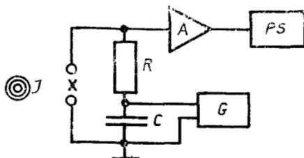
*I*—источник ионизирующего излучения; *X*—входные выводы установки; *R*—резистор утечки; *C*—блокирующий конденсатор; *A*—усилитель; *G*—источник рабочего напряжения; *PS*—измеритель временных интервалов
