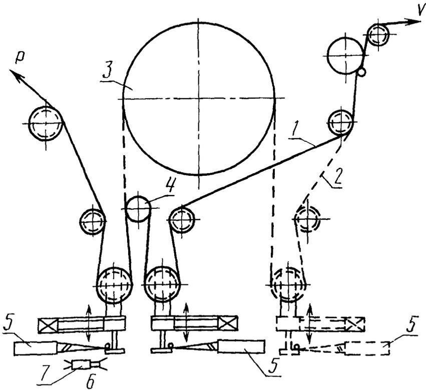
$P$ —усилие, равное 5 Н/мм<sup>2</sup>;  $V$ —скорость движения ленты (от 0,5 см/с до 20 см/с); 1—схема заправки ленты для определения коэффициента трения на основе; 2—схема заправки ленты для определения коэффициента трения на магнитном слое; 3—барабан; 4—штифт; 5—тягомер; 6—выключатель; 7—регистратор натяжения ленты
