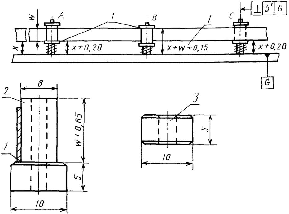
$W$ —ширина ленты;  $X$ —высота ленты на входе или выходе прибора; 1—расположение краев ленты; 2—направляющий ролик (A, B, C); 3—головка направляющего ролика (фланец)
