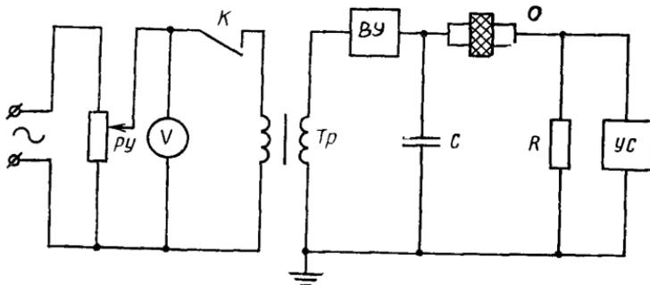
*Tr*—высоковольтный испытательный трансформатор; *R*—резистор; *РУ*—регулятор напряжения; *O*—образец с электродами; *V*—вольтметр для измерения напряжения пробоя; *ВУ*—выпрямительное устройство; *C*—конденсатор; *УС*—устройство сигнализации о наступлении пробоя; *K*—контакт устройства сигнализации, отключающий первичную цепь трансформатора в момент пробоя образца
