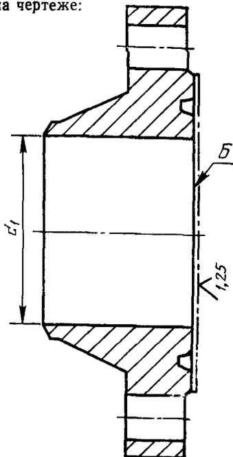
исключить обозначение поверхности А; выносной элемент 1 дополнить наименованием: «Под механическую обработку».
