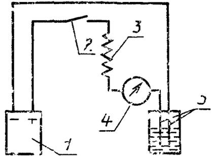
1 — сухой гальванический элемент на 1,2 В, 2 — переключатель, 3 — сопротивление  $\approx 10$  кОм, 4 — микроамперметр, обеспечивающий измерение силы тока до 100 мкА, 5 — платиновые электроды
