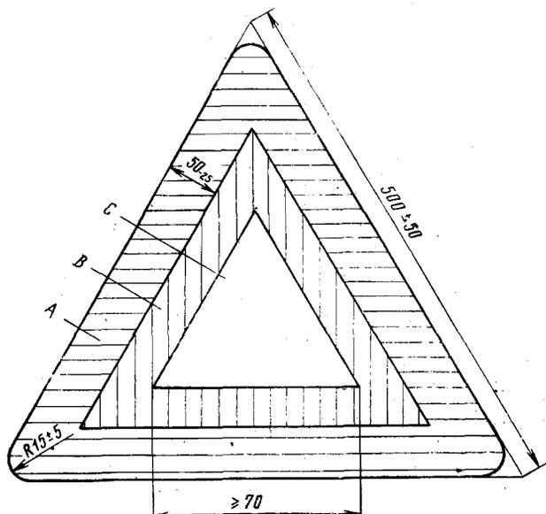
А—световозвращающая часть красного цвета; В—флуоресцирующая часть красного цвета для  $S \geq 315 \text{ см}^2$ ; С—треугольное отверстие
