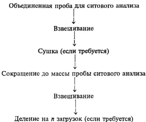
Рисунок 1 — Схема подготовки объединенной пробы к ситовому анализу
