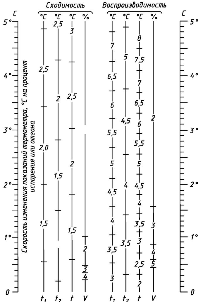
$t_1$  — температура начала кипения, °С;  $t_2$  — температура конца кипения или температура полного выкипания нефтепродукта, °С;  $t$  — температура при заданном проценте испарения или отгона, °С;  $V$  — процент испарения или отгона при заданной температуре
