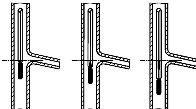
Рисунок 5 — Положение термометра в перегонной колбе
