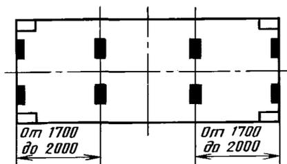
б) при 5 парах опорных (контактных) площадок
