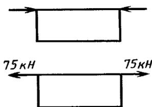
Только для 1D, 1DX при подъеме по черт. 3. (усилие определяется расчетом)
