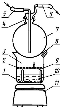
1 — противотурбулентные камни; 2 — опора для изделий; 3 — место для размещения изделий (высота около 75 мм, диаметр около 125 мм); 4 — зажимное приспособление для поддержки колбы; 5 — пуск охлаждающей воды; 6 — выход охлаждающей воды; 7 — двухлитровая колба из боросиликатного стекла; 8 — неплотно закрытый носик химического стакана; 9 — двухлитровый химический стакан из боросиликатного стекла; 10 — дистиллированной воды 800 см<sup>3</sup>; 11 — нагревательная плита
