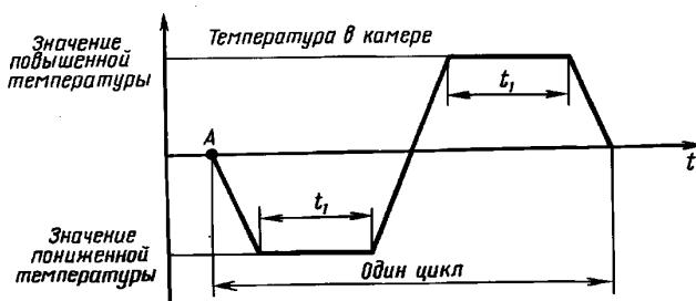
A — начало цикла;  $t_1$  — время выдержки
