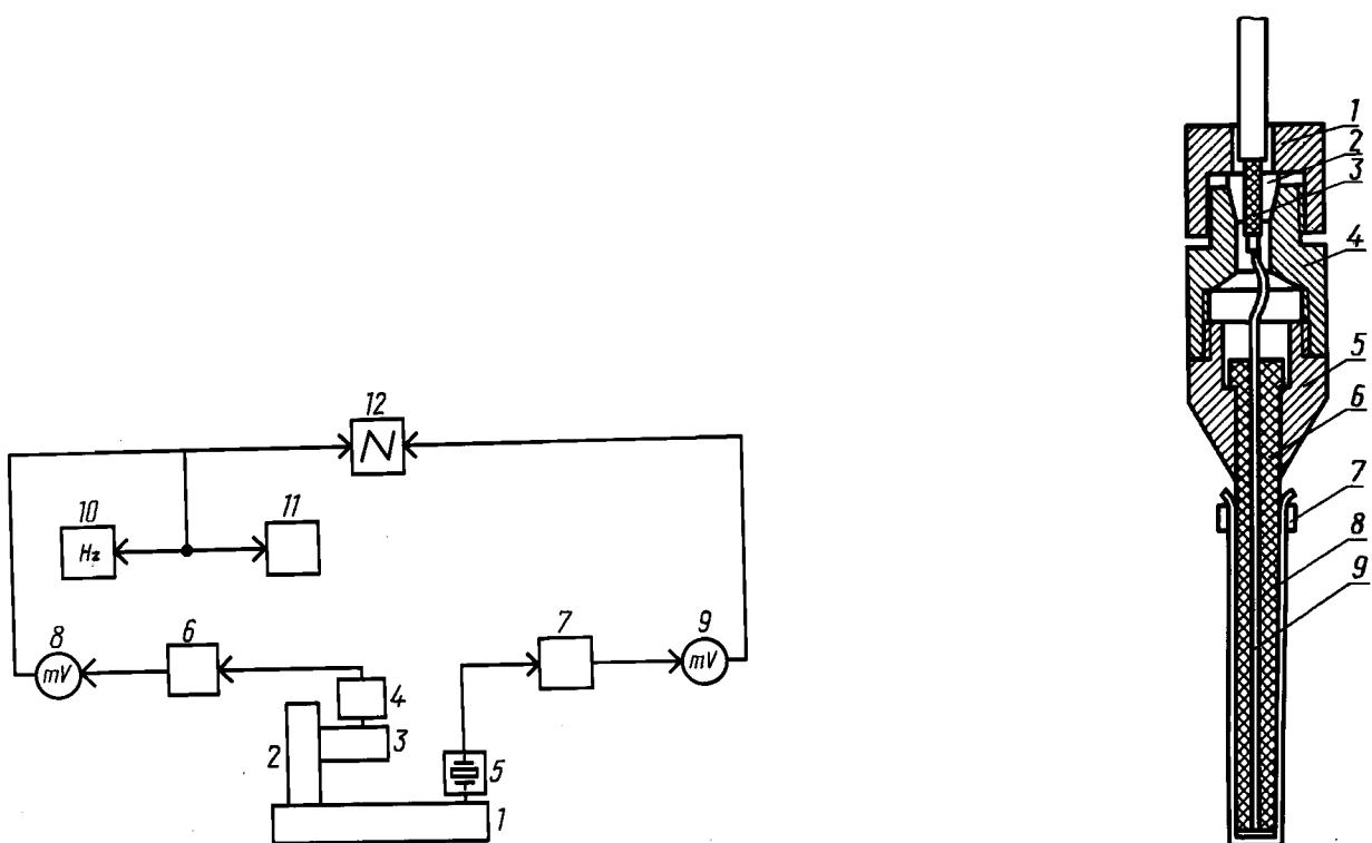
1 — стол вибростенда; 2 — приспособление для испытаний; 3 — испытуемое изделие; 4 — электретный вибропреобразователь; 5 — пьезоэлектрический вибропреобразователь; 6, 7 — катодные повторители; 8, 9 — милливольтметры; 10 — частотометр; 11 — самописец; 12 — осциллограф
