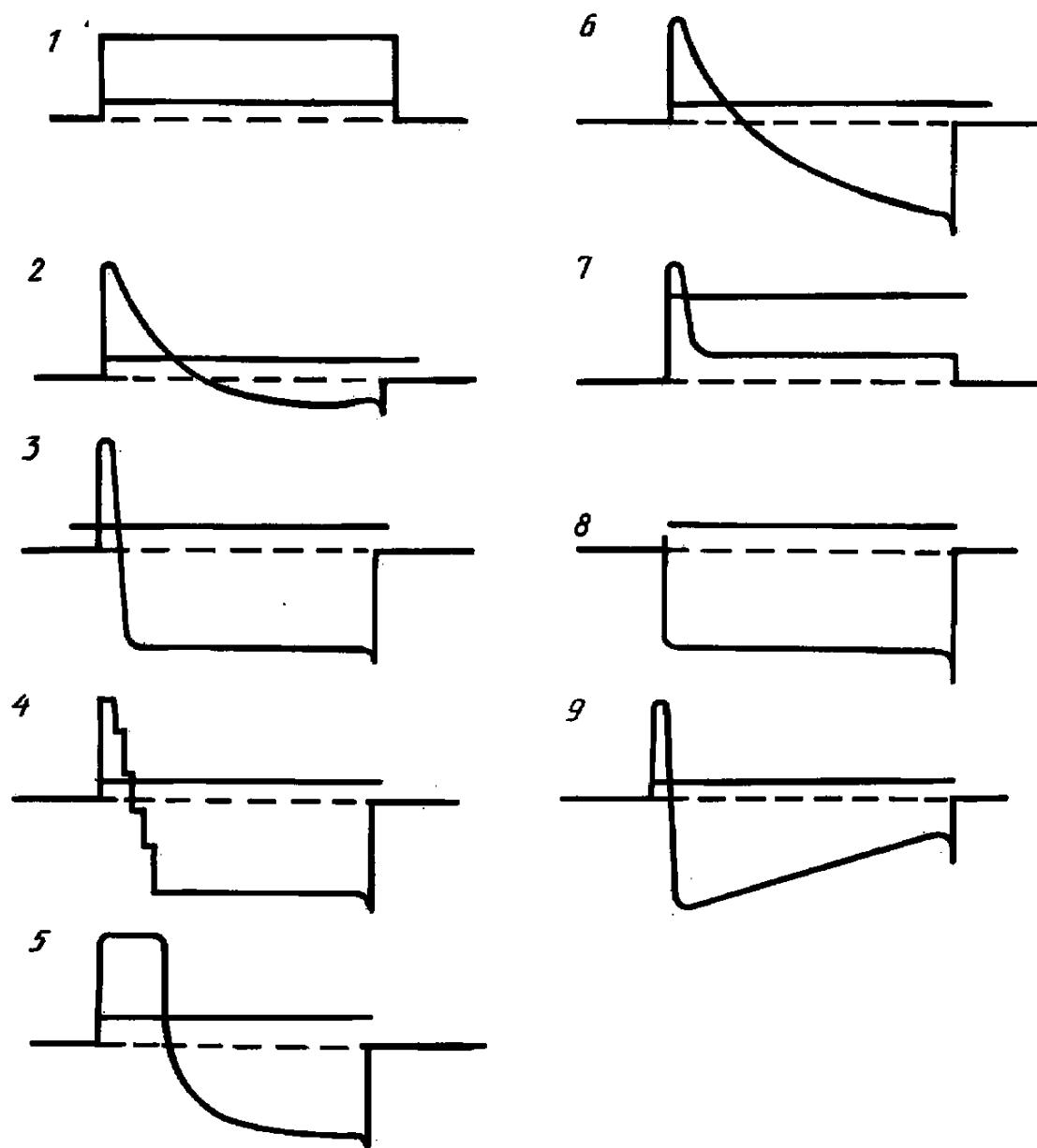
1 — несмачивание; 2 — плохое смачивание; 3 — хорошее смачивание;
