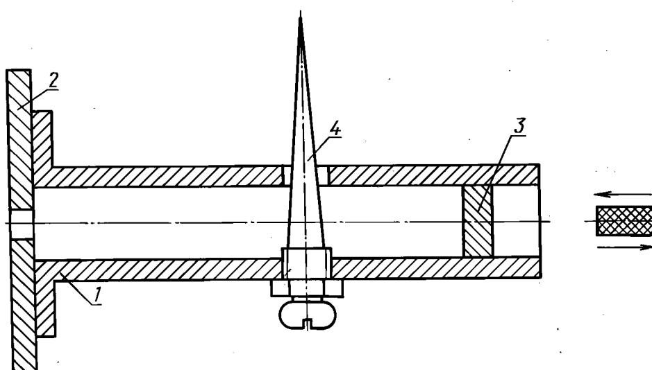
1 — волновод (10-23); 2 — диафрагма; 3 — поршень настройки; 4 — антенна
