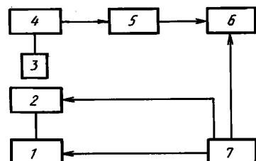
1 — устройство для подъема ванны; 2 — паяльная ванна; 3 — образец; 4 — устройство балансировки и преобразования сигнала; 5 — формирователь сигнала; 6 — самописец;
