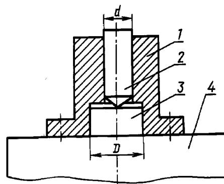
1 — корпус крещерного устройства; 2 — инерционный элемент; 3 — крещер; 4 — стол испытательного стенда
