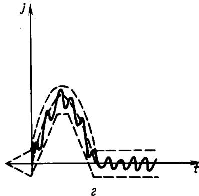
а — осциллограмма исходного импульса; б — выявление усредненного профиля импульса; в — нормированная форма импульса; г — оценка формы импульса
