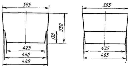
2.3. Поверхность чушек должна быть без окислов и включений. На поверхности чушек допускаются: местные включения окислов и плен на площади, не превышающей 10% общей поверхности чушек, на глубине до 10 мм; следы удаления окислов с поверхности жидкого металла и мелкие литейные дефекты, а также рыхлость в зоне усадки.
