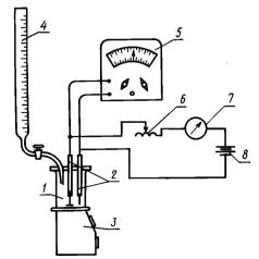
Установка для титриметрического определения алюминия с ампераметрической индикацией конца титрования (см. чертеж).
